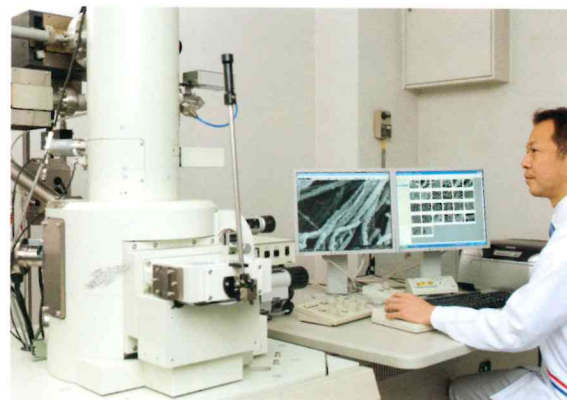
65万倍まで拡大できる大型の電子顕微鏡
